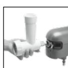
la pequeña perilla sobre el aditamento se encuentre debajo de la hendidura a la derecha de la abertura y gire ligeramente hacia adelante y atrás hasta que la perilla encaje con la hendidura y que el aditamento se bloquee.
