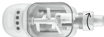
8. Para extrudir la pasta, empuje el cortador (3) en el soporte para disco (4) hasta que quede seguro. Colóquelo de manera que el marco del cortador rodee el disco para pasta.
